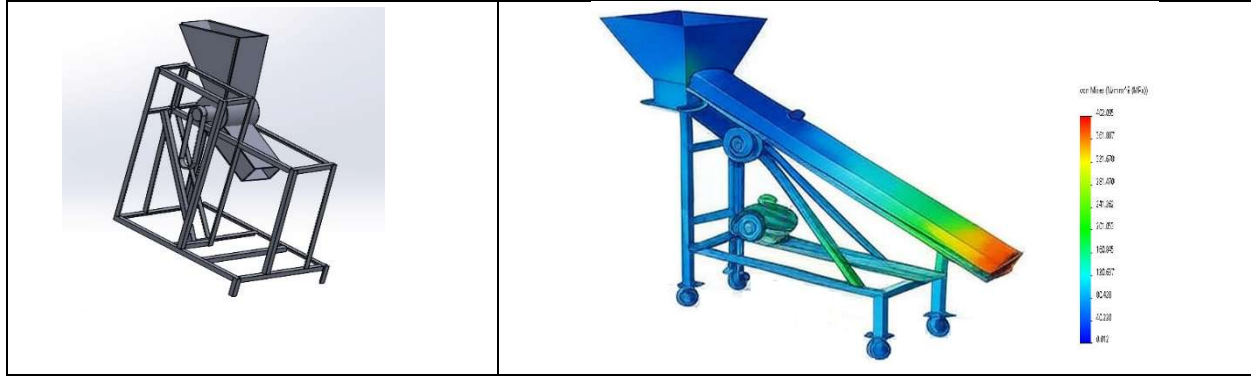
Figura.1 Diseño en SolidWorks y modelado en elemento finito
