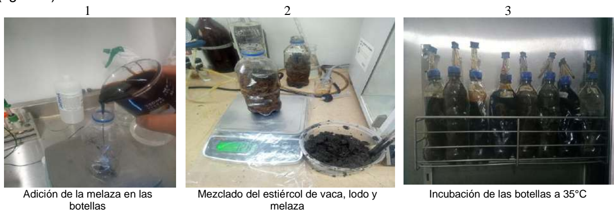
Figura 1. Montaje experimental para evaluar la producción de biogás
